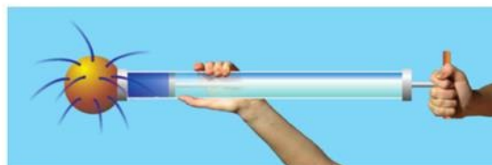
Рис. 19.3. Опыт показывает, что внешнее давление передаётся во все точки жидкости
