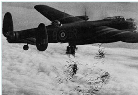
При подлете к зоне бомбардировки самолет рассыпал полоски Al фольги, которая отражала радиоволны как и самолет. В итоге самолет невозможно было обнаружить
